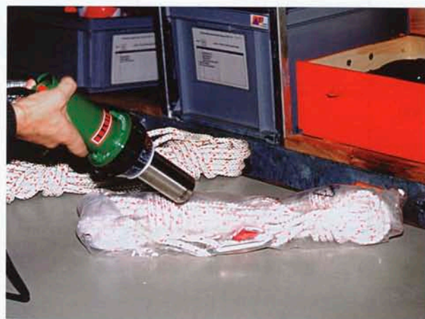
Усадка упаковочной пленки на спасательном канате аппаратом ЭЛЕКТРОН
